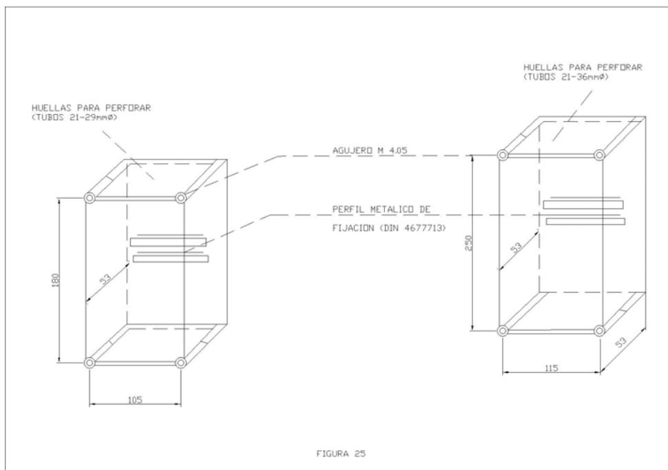
El perfil tendrá una longitud de 105 mm para que se pueda sujetar el contactor y el ICP.
